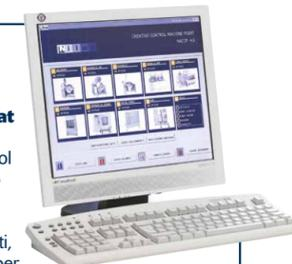
L'uso interattivo con il PC dello chef consente la completa rintracciabilità degli alimenti e l'archiviazione di tutti i dati. Il "CCMP" effettua anche l'autodiagnostica del funzionamento di **Dough.O.Mat** evidenziando gli allarmi e memorizzandoli.
