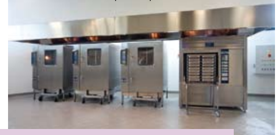
Forni misti e forno a vapore in pressione - zona cottura
