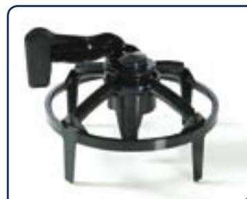
Spesso nei cutter, durante le lavorazioni, il prodotto rimane lontano dall'azione delle lame, perché centrifugato sulle pareti della coppa. Per eliminare questo inconveniente, i cutter **VCB 61&62** sono dotati di un sistema brevettato con quattro raschiatori che, anche a macchina in funzione, permettono il distacco del prodotto dalle pareti e la sua ricaduta sulle lame di taglio.
