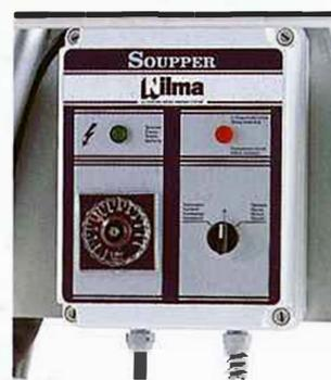
Quadro comandi, a bassa tensione (24 V), dotato di: selettore funzionamento manuale/stop/automatico, programmatore contalitri, spie di tensione e di collegamento errato. Grado di protezione IPX4.
